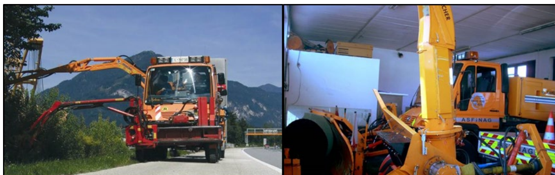
Abbildung 20 - Geräteträgerfahrzeug (Unimog) und Anbaugeräte (Zubehör)
