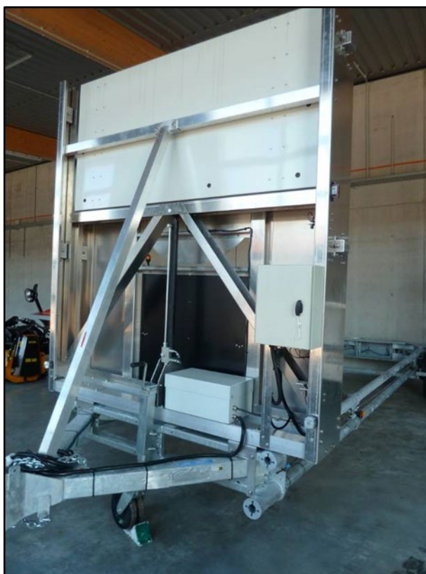
Abbildung 27 - Überlanger Vorwarnanhänger mit Anpralldämpfer
