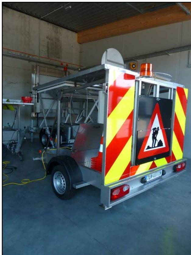
**Abbildung 25 - Warnleitanhänger (WLA)/Deckwagen**
