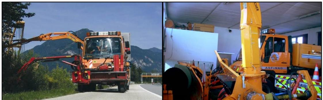
*Abbildung 20 – Geräteträgerfahrzeug (Unimog) und Anbaugeräte (Zubehör)*
