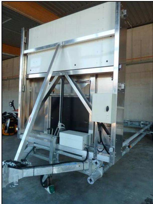
**Abbildung 27 - Überlanger Vorwarnanhänger mit Anpralldämpfer**
