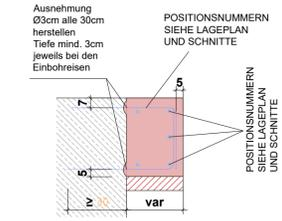
**DIE FUNDAMENTVERBREITERUNG MUSS 35cm VOM FAHRBAHN RAND (SIEHE DECKENBUCH) BETRAGEN, UM EIN GENÜGEND BREITES AUFLAGER FÜR DIE SCHLITZRINNE HERSTELLEN SIE KÖNNEN. EINE GESAMTBREITE DER FUNDAMENTVERBREITERUNG KANN NICHT ANGEZEIGT WERDEN, DA SIE VARIABEL IST (HÄNGT VOM BESTAND AB). DER BESTAND IST VOR ORT AUFZUMESSEN UND DIE FUNDAMENTVERBREITERUNG VOR ORT ANZUPASSEN.**
