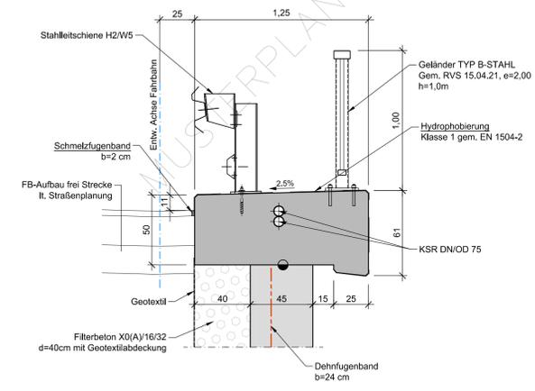
**Detail Ortbetonrandbalken (Beleuchtung)**
