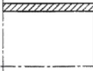
Das Rohr verfügt über eine glatte Innen- und Außenoberfläche. Die gesamte Wanddicke besteht aus der gleichen Formmasse/Zusammensetzung.
