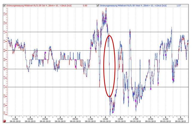
Strömungsänderung von +1ms auf -1ms in unter 2 Minuten
