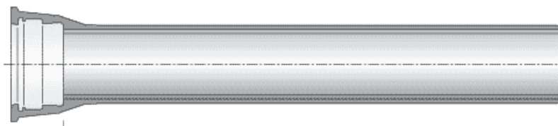
Abbildung 8 - Druckrohr mit Steckmuffenverbindung
