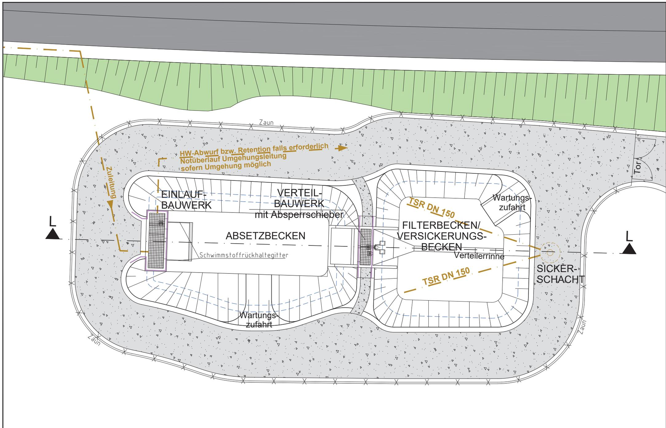
Anmerkung: Bei der Wartungszufahrt zum Becken auf eine ausreichende Dimensionierung der Kurvenradien achten - auf Radien der Wartungsfahrzeuge Rücksicht nehmen, bzw. Lage der Wartungszufahrt dementsprechend anordnen.
