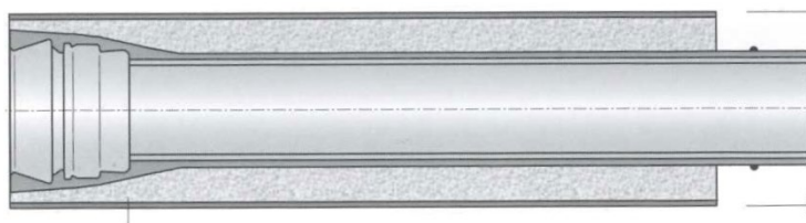
Abbildung 7: Wärmedämmtes Druckrohr mit Steckmuffenverbindung
