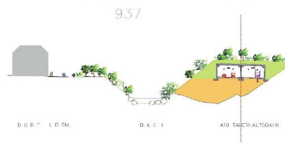
Einhausung mit Trassenverschiebung
